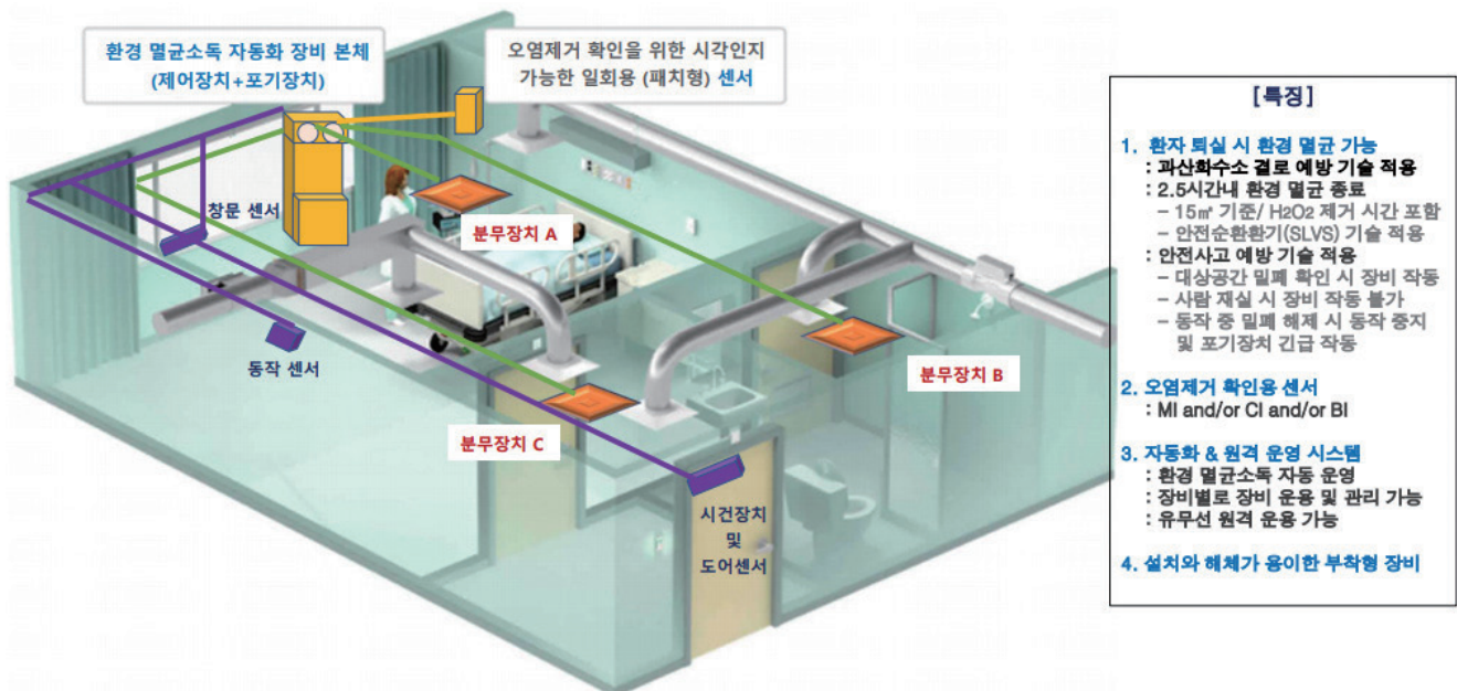
참고1. 의료환경 비접촉식 멸균소독 자동화 장비
